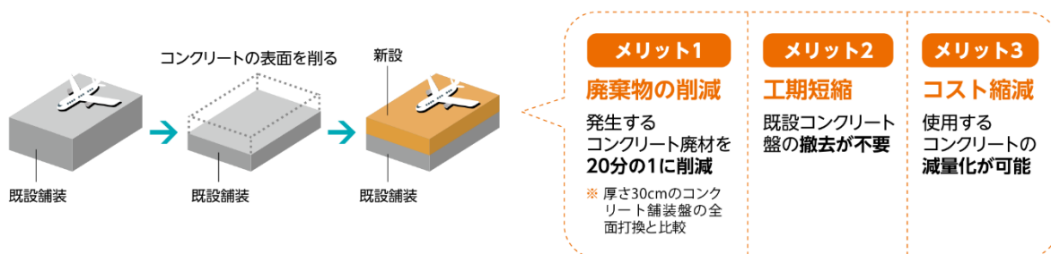
図 4.2-8 完全付着型オーバーレイ工法
