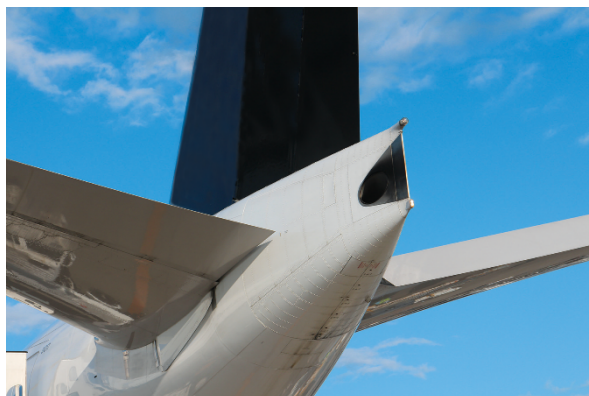
図 4.1-6 APU（補助動力装置）の排気口
