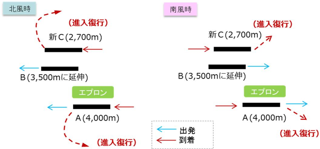
**案 2 : 案 1 の地上走行距離を短縮する観点から、風向きによる運用方法を工夫するため、新C滑走路の位置を南側へずらす案**
