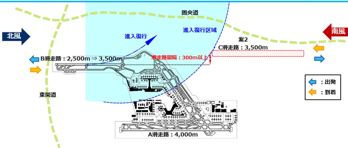
図 3.3-5(2) 第3滑走路（C滑走路）整備及びB滑走路延伸に関する3案の詳細
