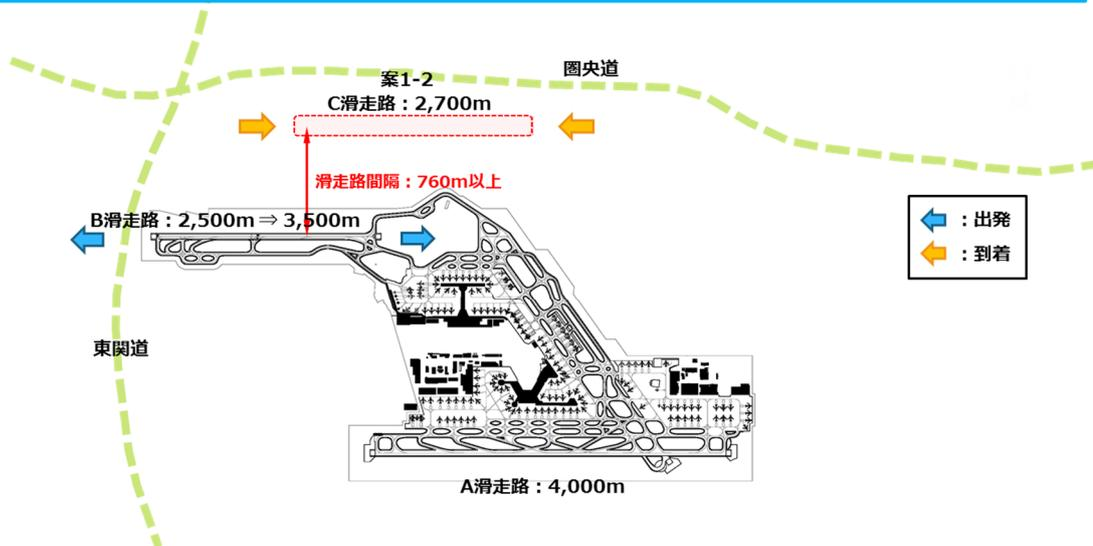
図 3.3-5(1) 第3滑走路（C滑走路）整備及びB滑走路延伸に関する3案の詳細
