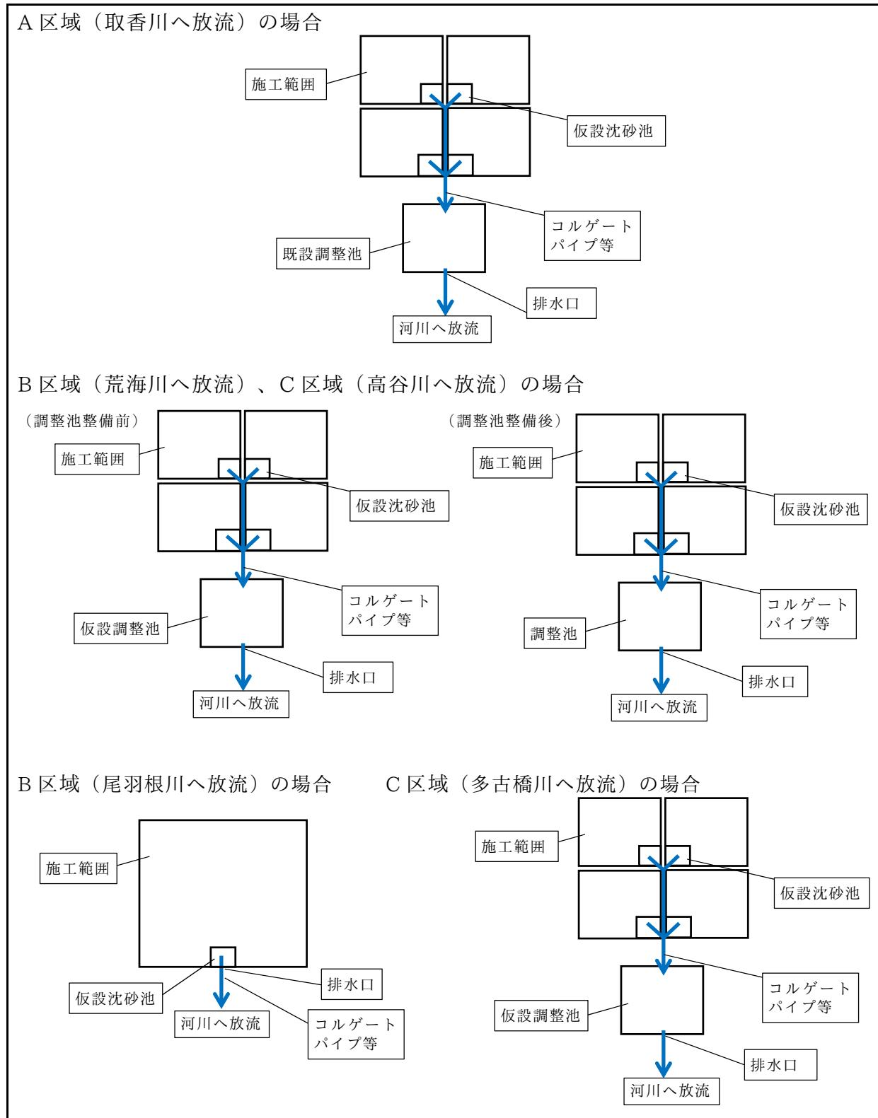
図 10.6.1-13 仮設沈砂池から河川への放流方法
