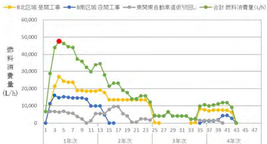
※ 燃料消費量は、B 北区域昼間工事・B 南区域夜間工事・東関東自動車道仮切回しにおける建設機械の燃料消費量を合計したものである。
