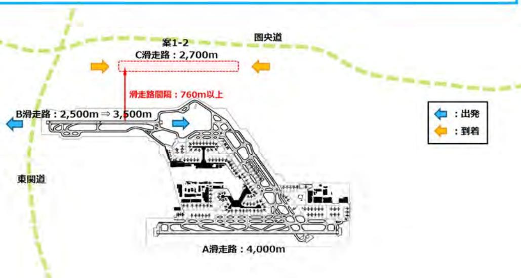
図 3.3-5(1) 第3滑走路（C滑走路）整備及びB滑走路延伸に関する3案の詳細
