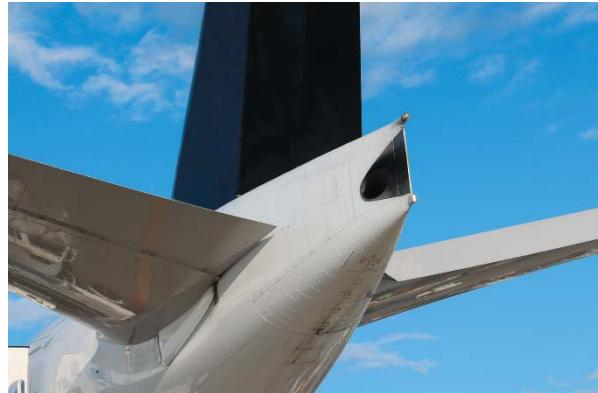
図 4.1-6 APU（補助動力装置）の排気口
