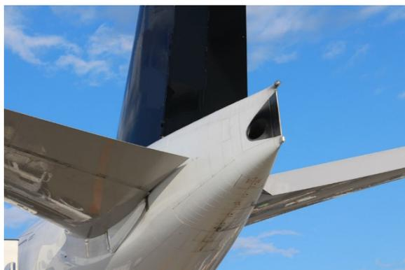
図 4.2-7 APU (補助動力装置) の排気口
