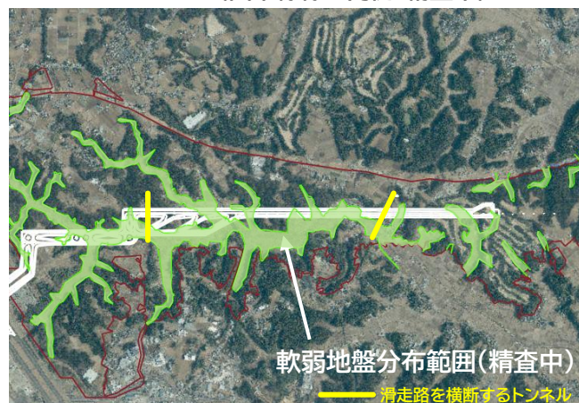
C滑走路地区:軟弱地盤の分布 (図中緑線の内側:精査中)
