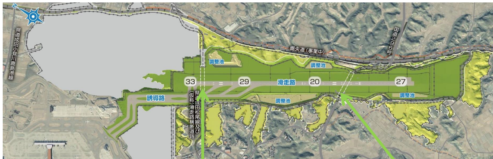
C滑走路地区:軟弱地盤の分布 (図中緑線の内側:精査中)
