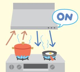
防音工事により設置可能なレンジフードは『深型タイプ』と『浅型タイプ』があり、深型タイプは給気と排気を同時にを行うことができますが、浅型タイプは同時給排ができない製品であるため、必ず防音工事の際に取り付けた給気用の換気装置と併せてお使いください。
